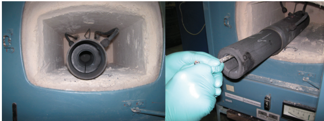
Рис. 5. Процесс извлечения обработанной облученной графитовой втулки из капсулы
