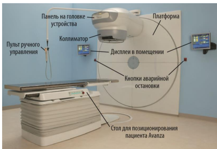
Рисунок 1. Гамма-терапевтический аппарат TheratronEquinox.
