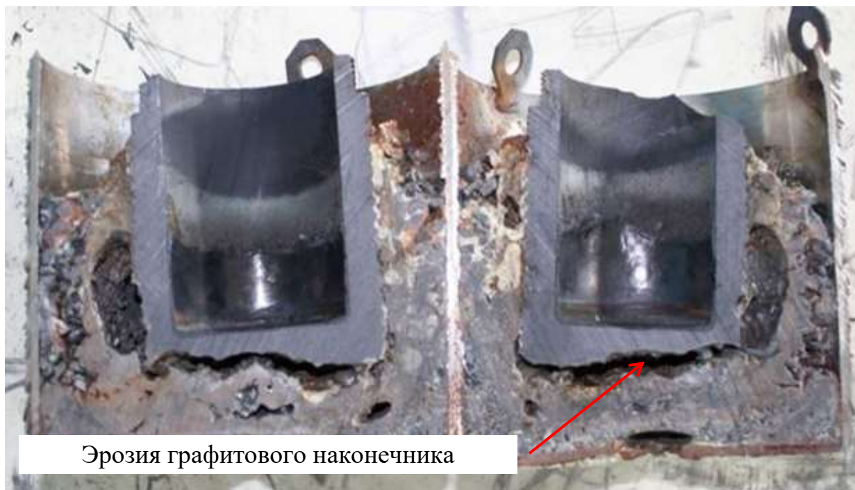
Рисунок 19 - Разрез наконечника плазматрона после ресурсных испытаний
