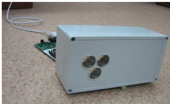
Рисунок 4.2 – Фотография разработанного ОЭП двух спектральных отношений для контроля взрывоопасной пылегазовой атмосферы
