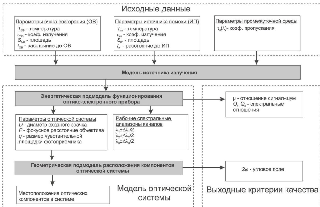
Рисунок 2.4 – Схема компьютерной модели оптической системы ОЭП двух спектральных отношений
