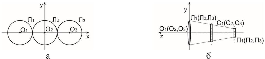
$O_1, O_2, O_3$  – центры входных зрачков;  $L_1, L_2, L_3$  – входные зрачки объективов каналов прибора;  $C_1, C_2, C_3$  – светофильтры;  $\Pi_1, \Pi_2, \Pi_3$  – приёмники излучения
