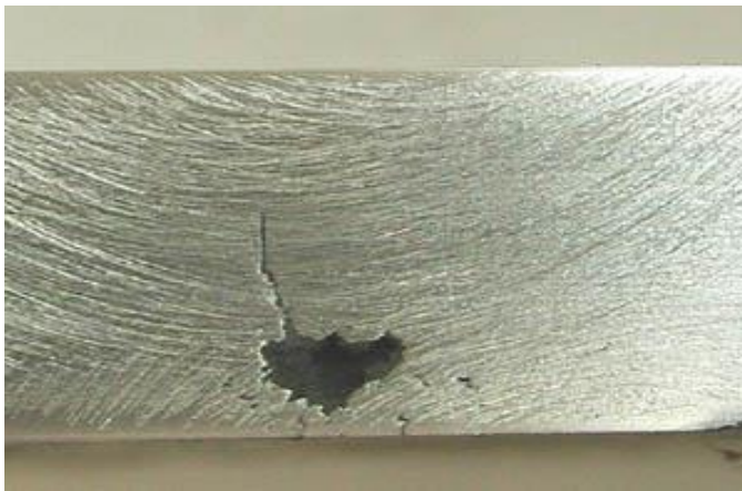
Рисунок 6.14 – Литейные дефекты в подповерхностном слое, обнаруженные при АЭ и ФЗ контроле в зоне наплавленного слоя боковых рам № 28343 (а) и 43230 (б), \times 2
