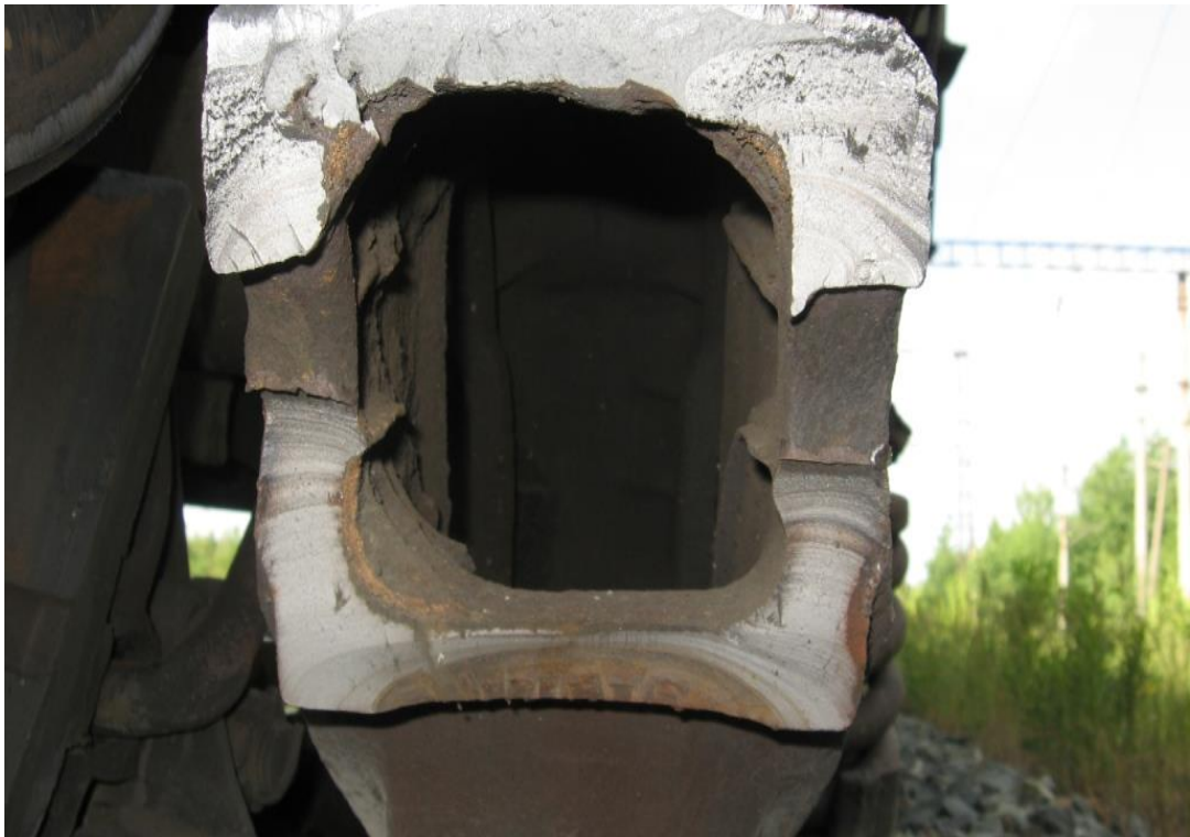
Рисунок 2.21 – Вид изломов боковых рам № 37744 (а) и № 39522 (б)
