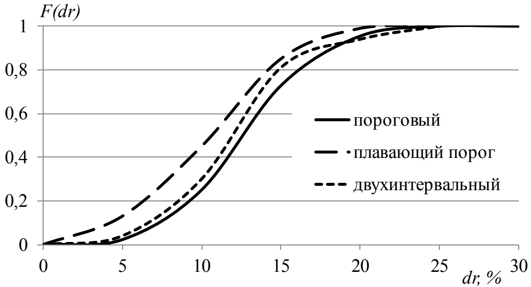
Рисунок 5.8 – Динамика изменения вероятности определения координат источника с погрешностью dr для сигналов с амплитудой 6–12 дБ относительно пороговой при определении времени прихода разными методами
