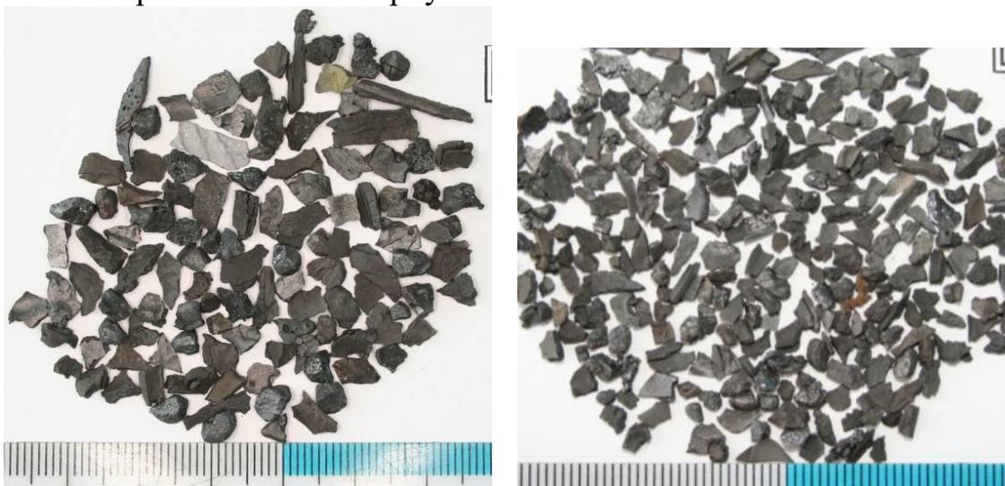
**Рисунок 12** – Фрагменты затвердевшего кориума, эксперимент INVECOR-4.
