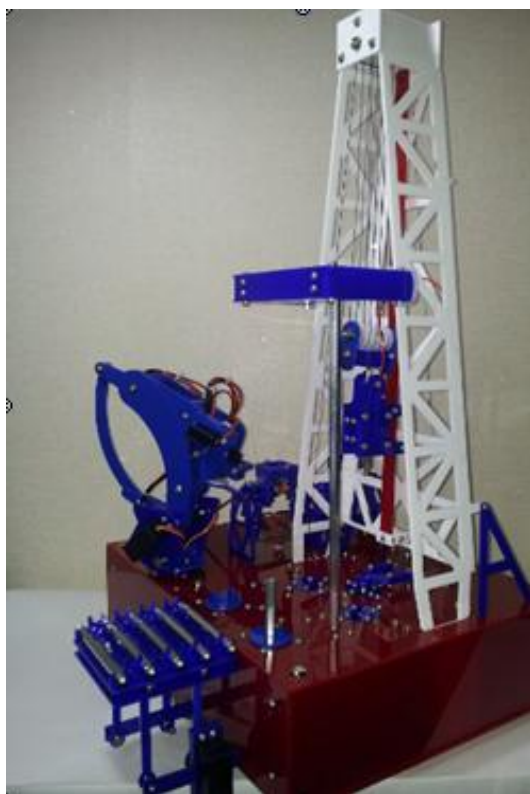
Рис. 1. Модель роботизированной буровой установки
