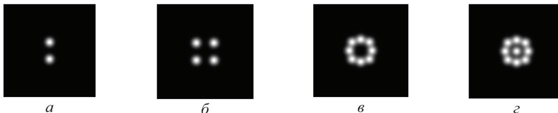
Рис. 2. Геометрия расположения оптических волокон на излучающей апертуре лазерной системы включающей 2 (а), 4 (б), 8 (в) и 9 (г) каналов
