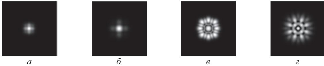
**Рис. 3.** Распределение интенсивности излучения в плоскости наблюдения для системы, включающей 4 (а, б) и 8 (в, г) каналов. Расстояние между центрами  $d=1,5$  для всех рисунков. Длина трассы  $Z=1,5$  (а, в) и  $Z=3$  (б, г) нормирована на дифракционную длину излучения
