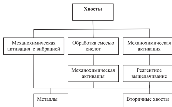
Рис. 8. Схема извлечения металлов из хвостов обогащения
