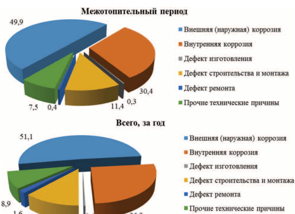
Рис. 8. Распределение дефектов трубопроводов «подземной прокладки в непроходных каналах» по причинам в межотопительный период и всего за год (%)
