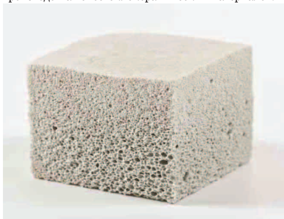
Рис. 7. Образец, полученный при вспенивании исследованной породы
