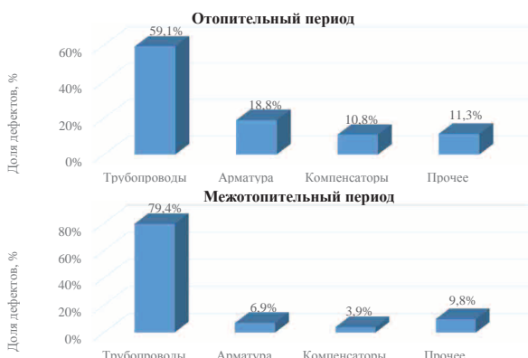
Рис. 4. Количество повреждений по виду оборудования в отопительный и межотопительный периоды (%)
