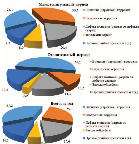
Рис. 11. Распределение дефектов трубопроводов «надземная прокладка» по причинам в отопительный и межотопительный периоды (%)
