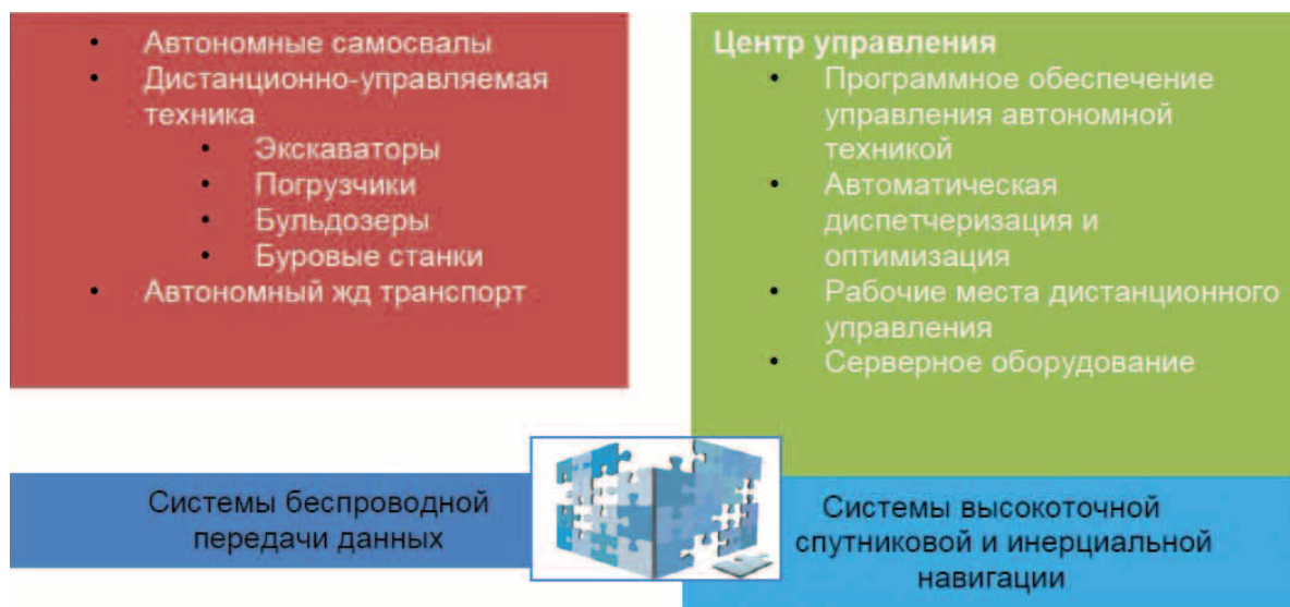
Рис. 1. Структура роботизированной системы на горном предприятии
