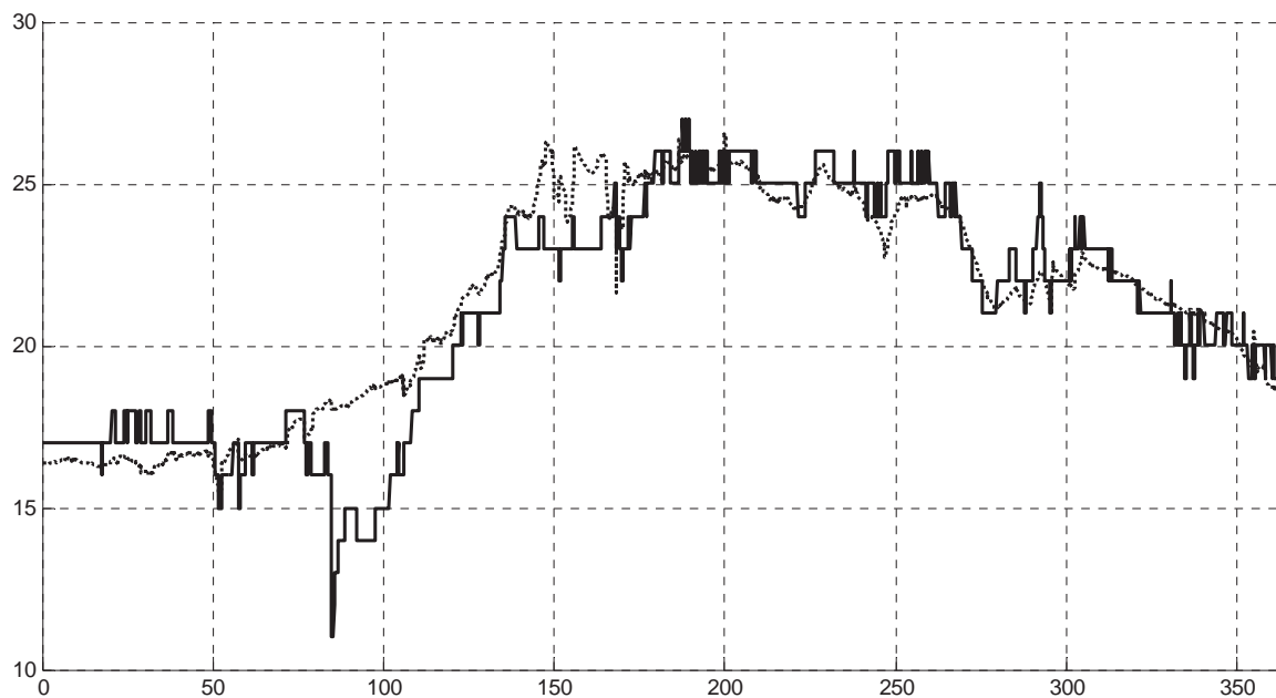
Рис. 4. Температура газа на выходе линейного участка газопровода (сплошная линия) и на выходе модели (пунктир)
