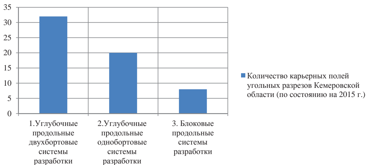
Рис. 1. Распределение видов систем открытой разработки по количеству карьерных полей угольных разрезов Кемеровской области
