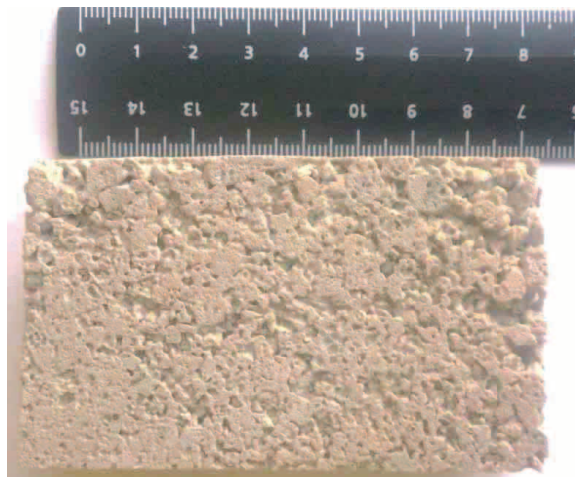
Рис. 5. Образец пеностеклокерамики, полученный при вспенивании исследованной породы
