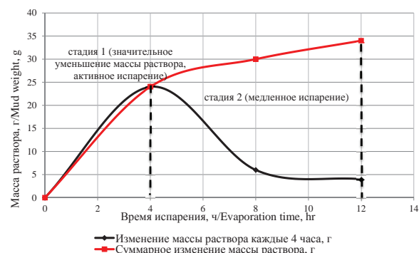
Рис. 3. Кинетика испарения эмульсионного раствора на основе масла «И-5А»
