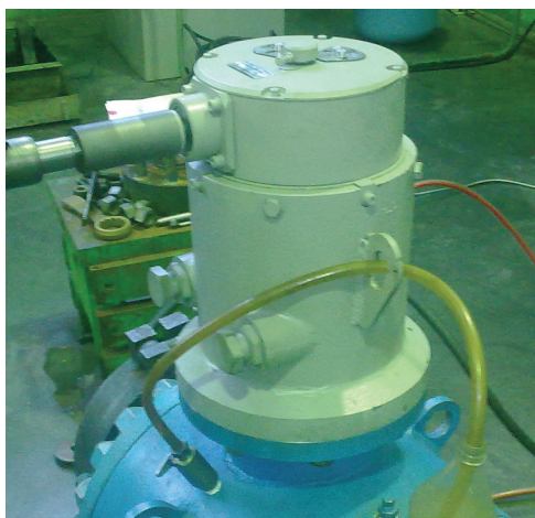
Рис. 2. Привод шарового крана и редукторная вставка винтового насоса
