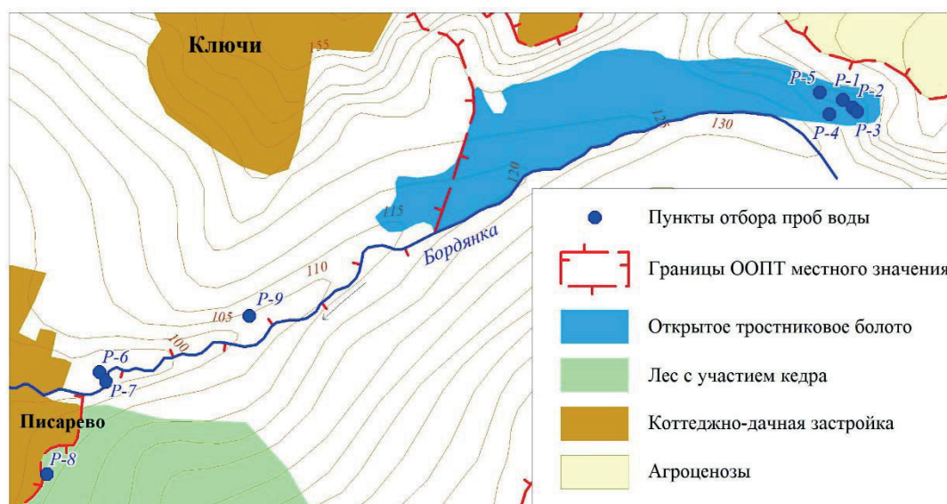
Рис. 3. Схема отбора проб воды по р. Бордянке
