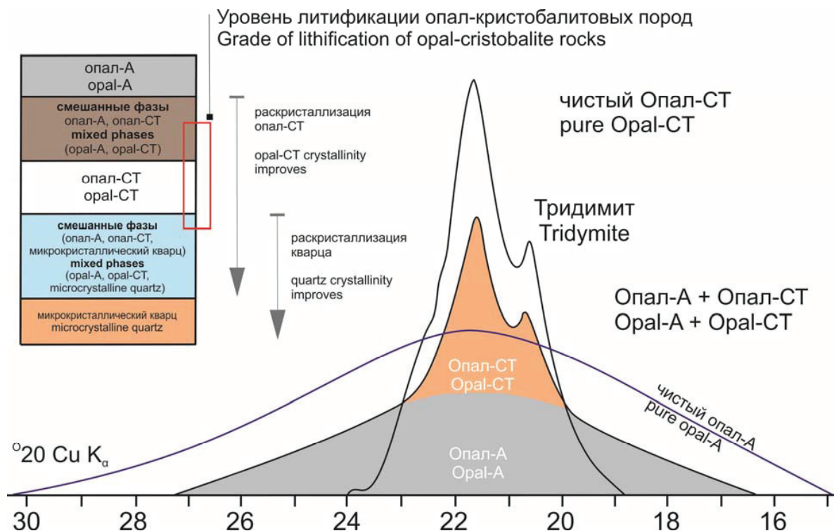
Рис. 2. Система полиморфных переходов минералов кремнезема (по J. Warren [23]) и уровень литификации опал-кristобалитовых пород Зауралья (по данным автора [1, 20])
