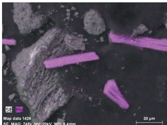
Рис. 7. Неравномерное распределение Mg, в виде собственной минеральной фазы в ЗООЧ г. Норильска
