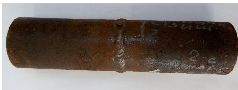
Рис.4. Образец сварного соединения
