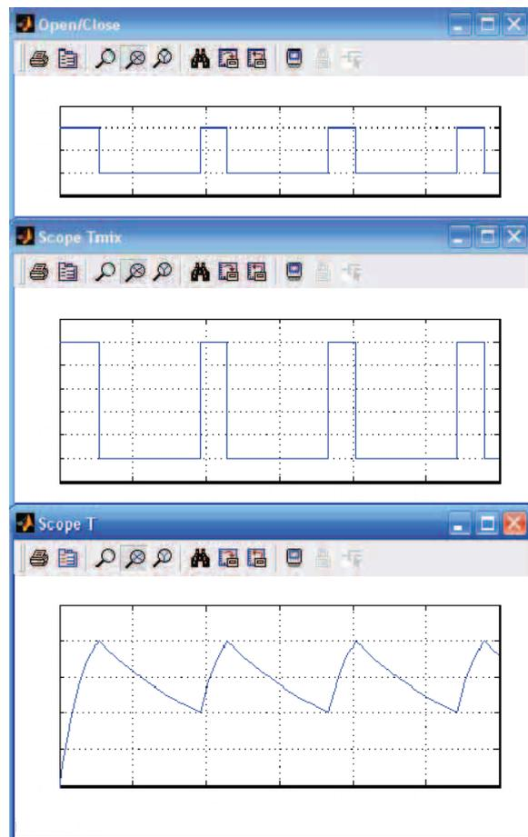
Рис. 7. Изменение температуры в баке при разных входных потоках
