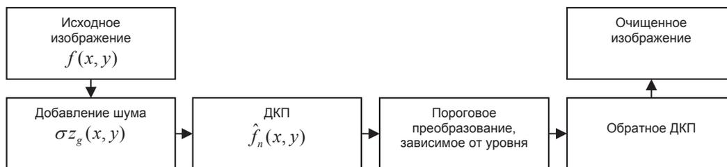
Рис. 3. Схема метода предобработки при помощи кривлет-преобразования
