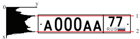
Рис. 4. Построение горизонтальных гистограмм. Линиям 1 и 2 соответствуют два наибольших максимума. x – номер строки изображения, y – средняя интенсивность строки изображения
