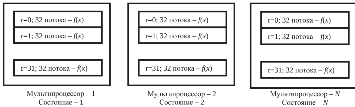
Рис. 4. Параллельная схема вычисления значений вероятности модели во всех состояниях для всех обучающих образцов
