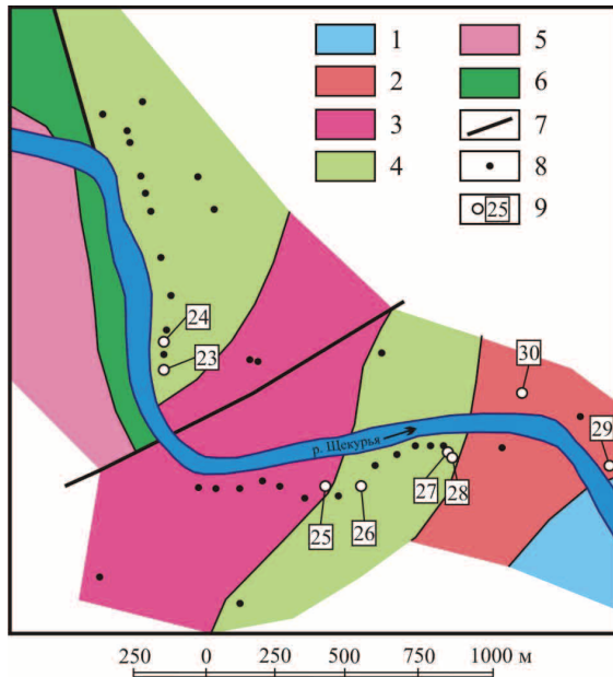
Рис. 3. Схема геологического строения участка детальных исследований вулканитов Щекуринского разреза: 1) мезозойско-кайнозойские отложения; 2) риолиты, дациты; 3) андезиты, литокластолавы андезитового состава; 4) базальты, андезитобазальты; 5) диориты; 6) полосчатые габбро; 7) разрывные нарушения; 8) точки наблюдения; 9) точки геохимического опробования и их номера
