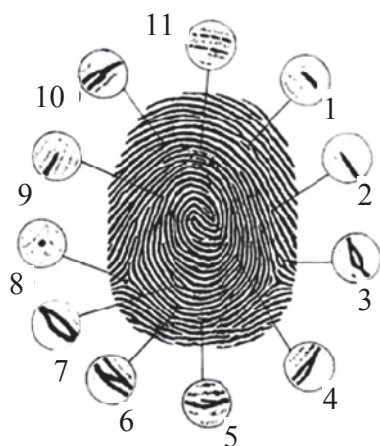
Рис. 2. Типы точек минуции: 1) фрагмент папиллярной линии; 2) начало папиллярной линии; 3) глазок; 4) бифуркация; 5) крючок; 6) мостик; 7) островок; 8) точка; 9) окончание папиллярной линии; 10) бифуркация-слияние; 11) включение
