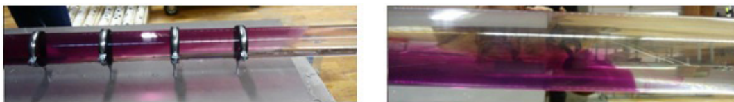
Рис. 2. Эффект термогравитационного расслоения флюида: а – внедрение горячего флюида; б – внедрение холодного флюида
