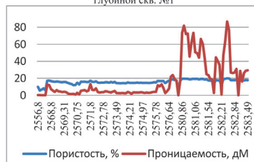
Рис.8 График изменения пористости и проницаемости с глубиной скв. №3
