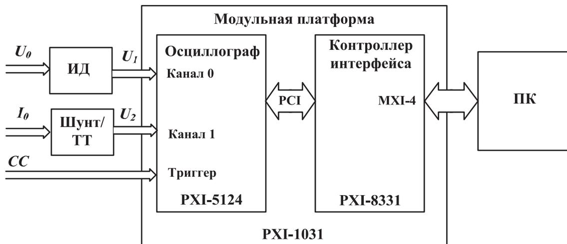
Рис. 1. Структурная схема цифрового измерителя мощности ЦИМ-1.1
