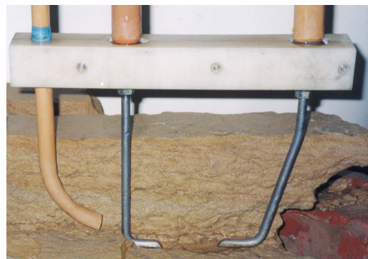
Рис. 2. Фотография двухстержневого резака и разрезанного им образца песчаника
