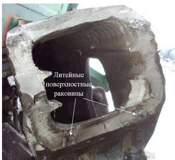
Рисунок 3 – Излом боковой рамы с источником – литейным дефектом, выходящим на поверхность
