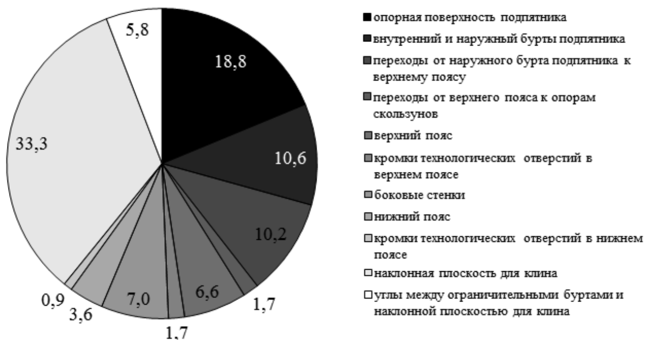
Рисунок 1 – Распределение усталостных трещин в надрессорных балках по участкам детали в % от общего числа обнаруженных при контроле магнитными методами и визуально
