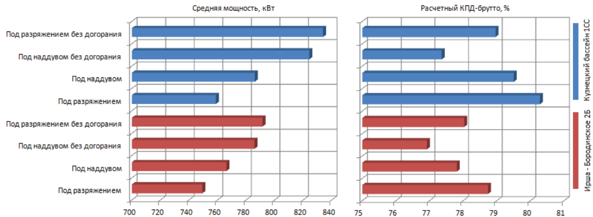
Рис. 6. Интегральные характеристики (КПД и производительность) котла KWr-0,8 с различной реализацией аэродинамики при сжигании твердого топлива марок 2Б (Ирша-Бородинское месторождения) и 1СС (Кузнецкий бассейн)
