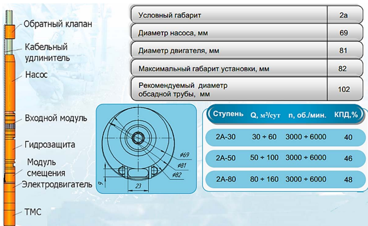
Рисунок 18 Конструкция и технические характеристики насосов УЭЦН 2А
