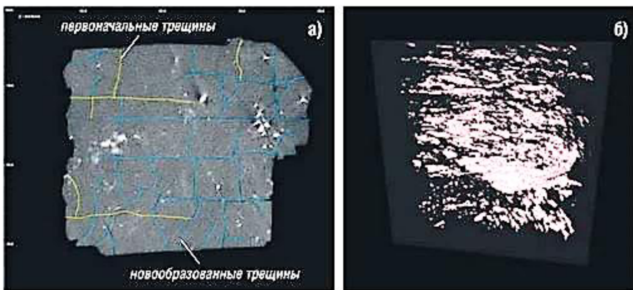
Рисунок 12 Рентгенополосный срез образца угля марки ГЖ:
