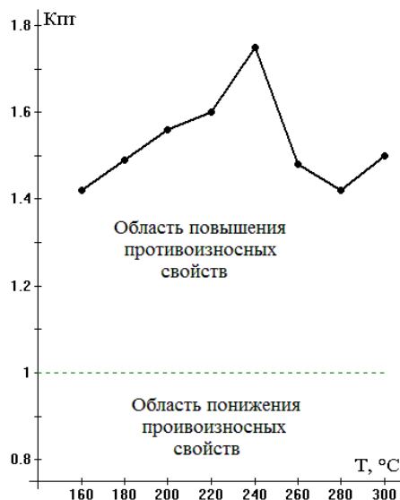
Рисунок 14 – Зависимость коэффициента влияния предварительного термостатирования от температуры термостатирования частично-синтетического моторного масла Лукойл Супер 10W-40 SG/CD
