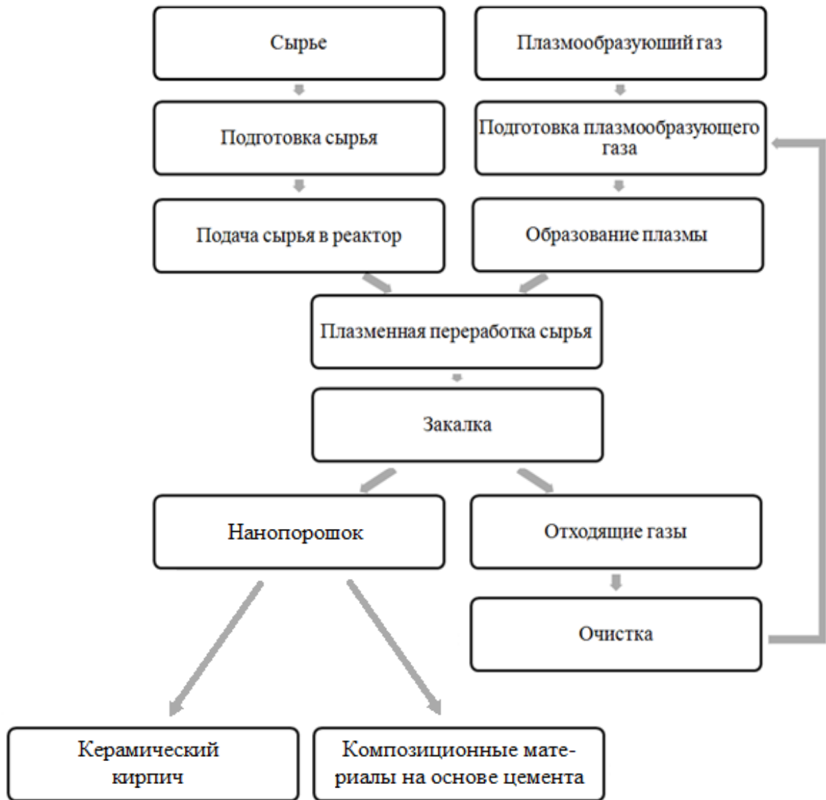
Рисунок 4.13 – Технологическая схема получения и применения нанопорошка диоксида кремния
