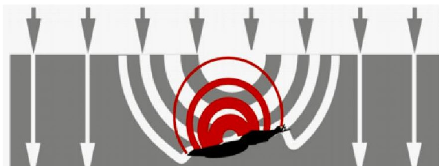
Рисунок 1.4 – Схемы обнаружения дефекта активной термографией
