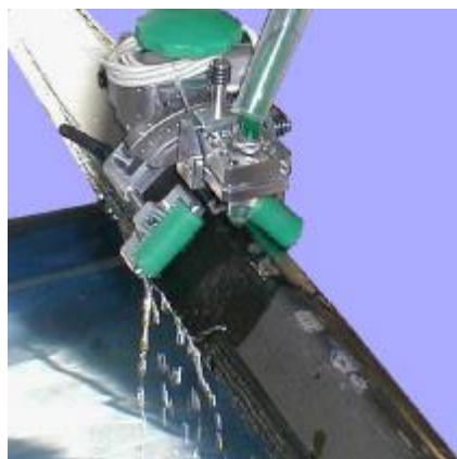
Рис.1.8. Пример использования ультразвукового дефектоскопа Sonotron ISonic AUT 16
