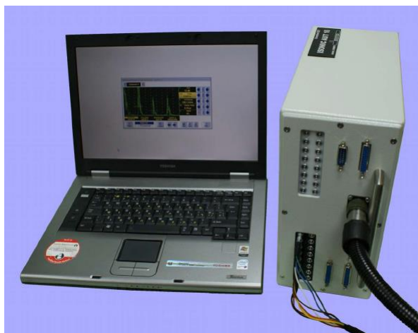
Рисунок 1.7 - Ультразвуковой дефектоскоп Sonotron ISONIC AUT 16
