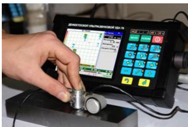
Рисунок 1.12 - Ультразвуковой дефектоскоп УД4-76.
