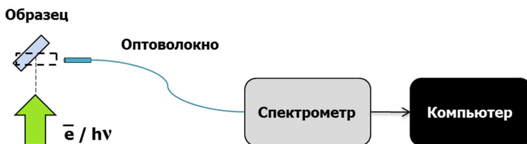
Рисунок 2.6 – Блок-схема измерения интегральных (за импульс возбуждения) спектров КЛ и ФЛ исследуемых образцов
