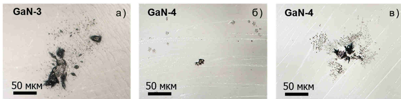
Рисунок 4.12 – Микроразрушения в виде «россыпи» тёмных пятен и точек в образцах GaN-3 (а) и GaN-4 (б, в), образовавшихся после 20 импульсов облучения СЭП с H = 0,6 \text{ Дж/см}^2
