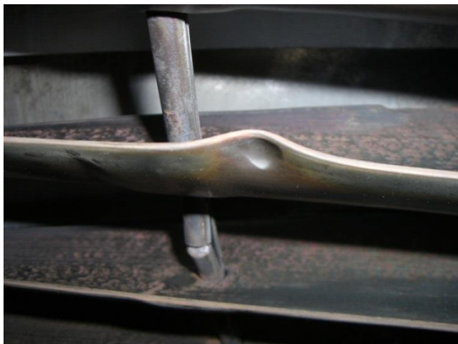
Рисунок П1.6 – Вмятины на рабочих лопатках последней ступени ЦНД
