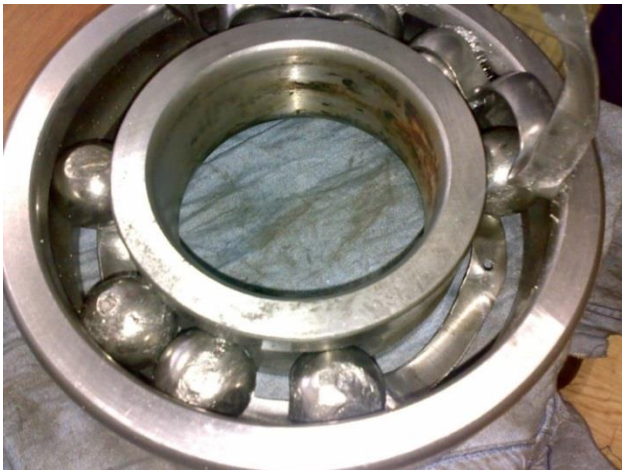
Рисунок П1.14 – Повреждения подшипника
