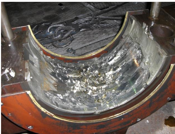
Рисунок П1.16 – Повреждения подшипника
