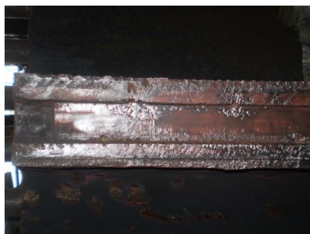
Рисунок П1.23 – Повреждения цилиндра среднего давления турбоустановки Т-100/120-130
