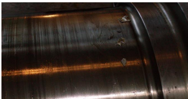
Рисунок П1.20 – Повреждения ротора
