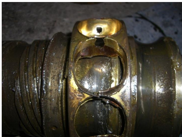
Рисунок П1.18 – Повреждения КН-8В
