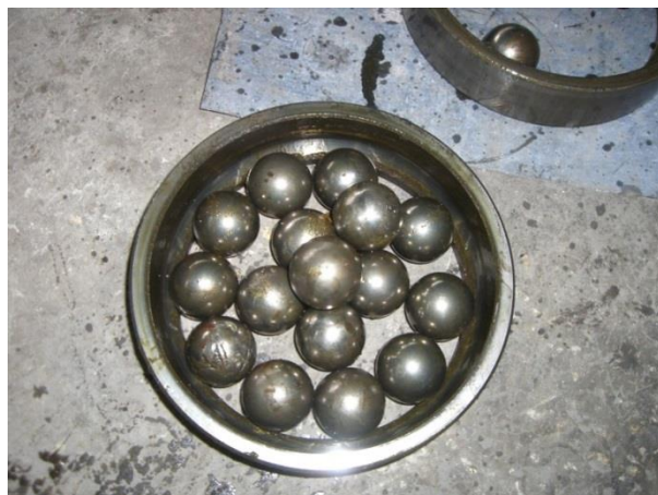
Рисунок П1.19 – Повреждения КН-8В
