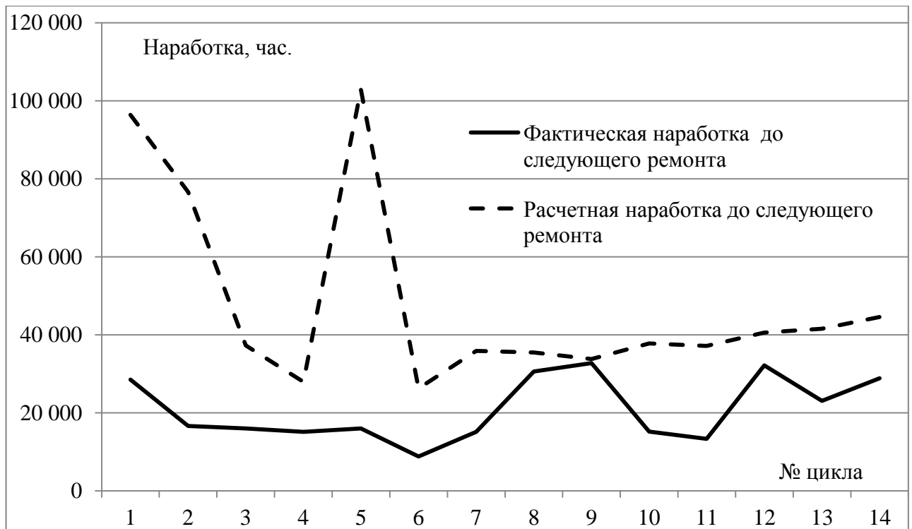
Рисунок 4.23 – Сравнение фактического и расчётного остаточного ресурса турбины ПТ-60-90-13 ст. № 9 Омской ТЭЦ-3 для каждого производственного цикла
