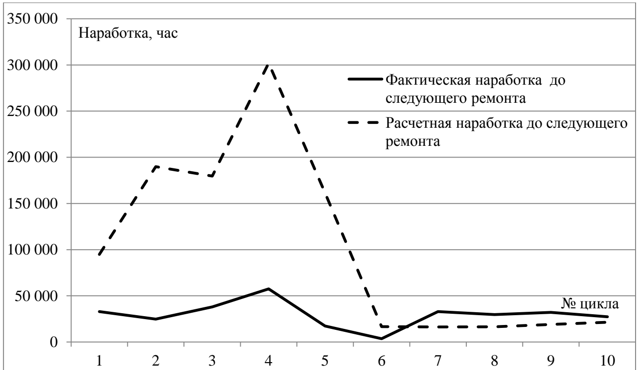
Рисунок 4.22 – Сравнение фактического и расчётного остаточного ресурса турбины ПТ-25-90/10 ст. № 2 Омской ТЭЦ-3 для каждого производственного цикла
