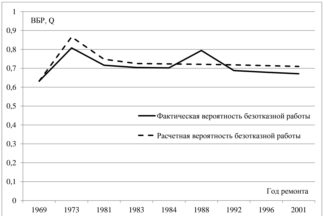
Рисунок 4.27 – Фактическая и расчётная вероятности безотказной работы турбоагрегата ПТ-25-90/10 ст. № 2 Омской ТЭЦ-3
