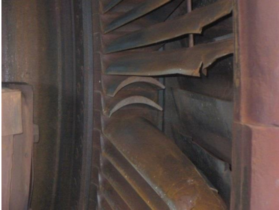
Рисунок П1.1 – Обрыв лопаток последней ступени
