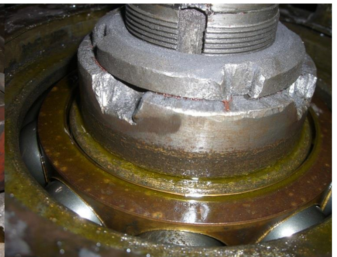
Рисунок П1.17 – Повреждения КН-8В
