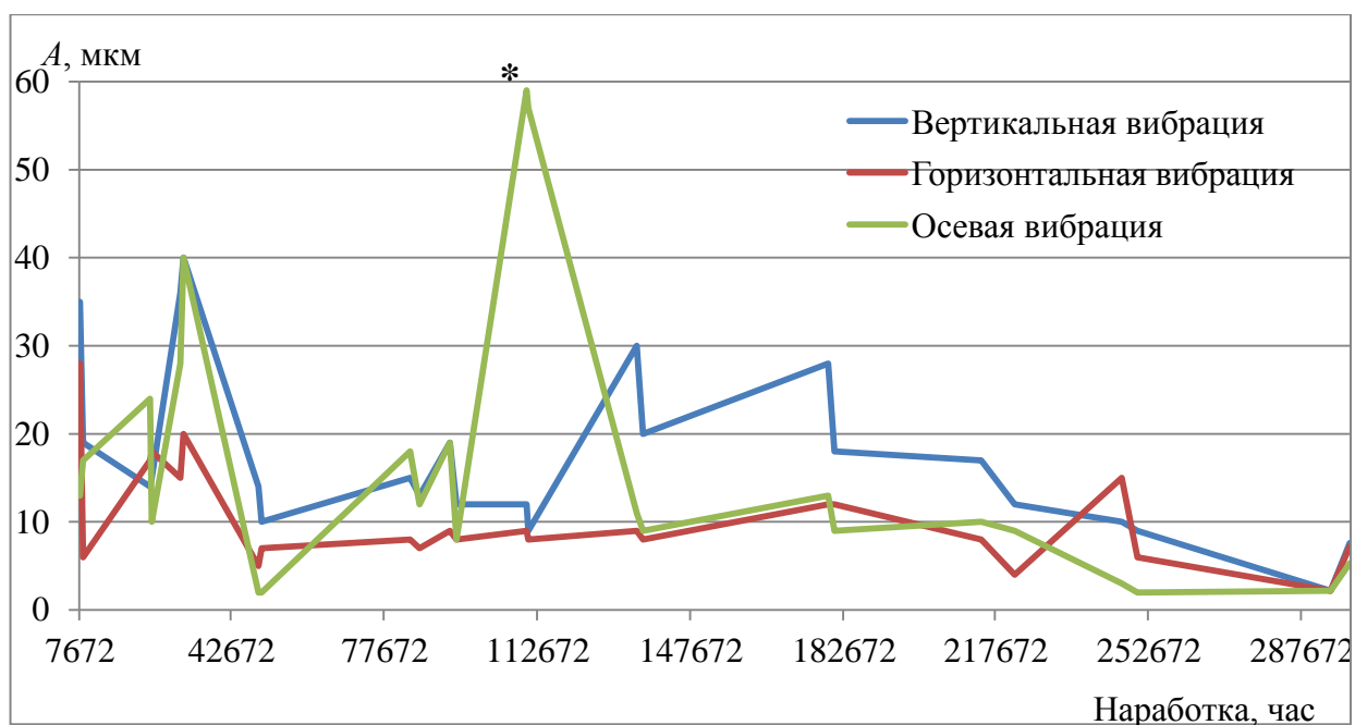
Рисунок 4.5 – Изменение уровней вибрации подшипника №3
