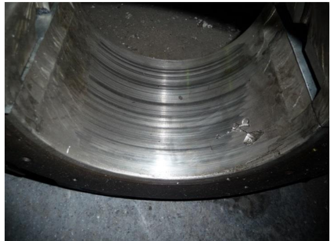
Рисунок П1.15 – Повреждения подшипника
