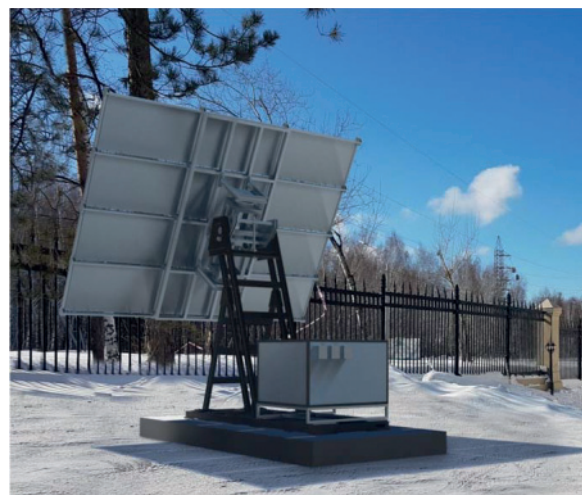
Рис. 5. Солнечная панель со следящей системой (разработка Томского политехнического университета)
