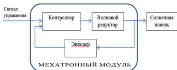
Рис. 4. Блок-схема мехатронного модуля солнечной панели
