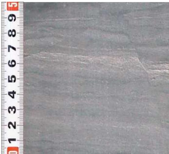
Рисунок 4.7 - Алевролит глинисто-песчанистый с горизонтальной и градационной слоистостью, с редкими песчаными прослоями и трещинами уплотнения. Фация *озера*. Гл. 2463.10 м. Скв. 15Р Казанского месторождения
