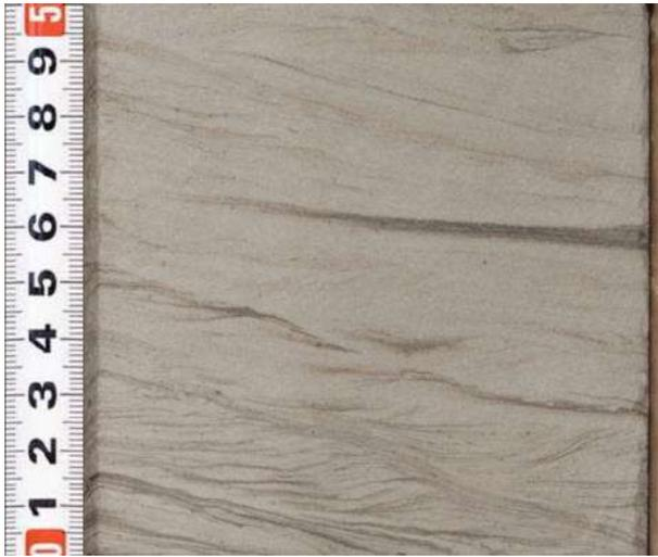
Рисунок 4.5 - Песчаник тонкозернистый однонаправленной косой слоистостью. Фация *конуса прорыва*. Гл. 2499.9 м. Скв. 106 Болтного месторождения
