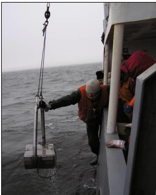
Рисунок 4.2 – Технические средства отбора проб донных осадков: а) дночерпатель типа Van Veen; б) пробоотборник осадков и придонной воды GEMAX
