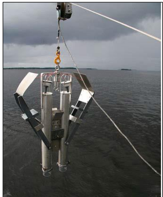
Рисунок 4.2 – Технические средства отбора проб донных осадков: а) дночерпатель типа Van Veen; б) пробоотборник осадков и придонной воды GEMAX
