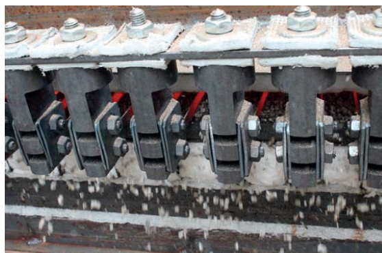
Рис. 4. Выход вспученного вермикулита из пространства обжига (на переднем плане – крепежные головки)
