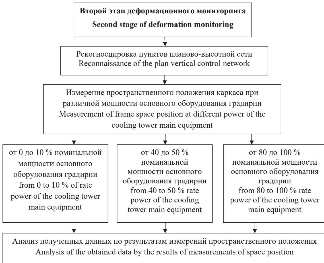
Рис. 11. Технологическая схема второго этапа деформационного мониторинга
