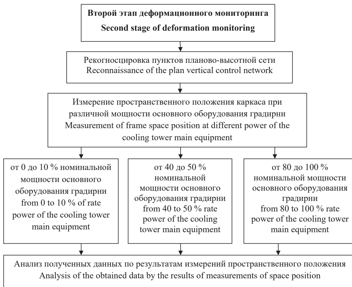
Рис. 11. Технологическая схема второго этапа деформационного мониторинга
