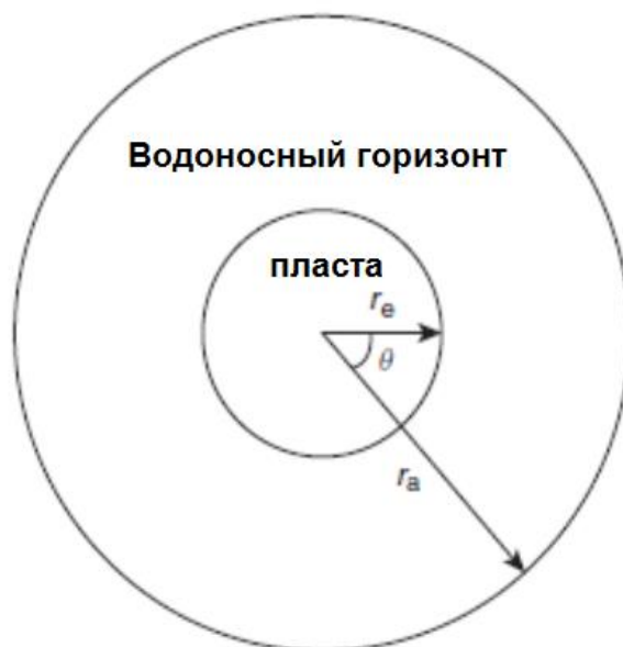
Рисунок 3.12 – Круговой пласт с водоносным горизонтом.
