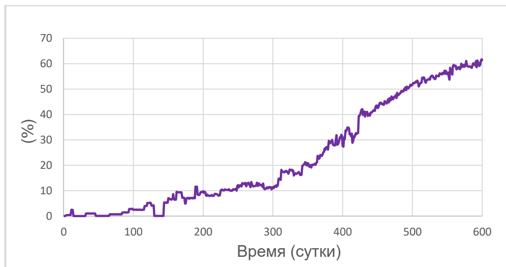
Рисунок 4.8 – График обводнения скважины Н2 Скважина Н2 имеет самый большой дебит из 3 скважин месторождения «Х» и ,в настоящее время, все еще эксплуатируется. Обводнение скважины Н2 увеличивается со временем, но медленнее, чем в двух других скважинах. Причина в том, что скважина Н2 расположена в верхней части структуры пласта, которая далека от водоносного горизонта, поэтому обводнение происходит медленнее. На основании рисунка 4.8 было установлено, что после 600 дней эксплуатации обводненность скважины Н2 составляла около 60%.
