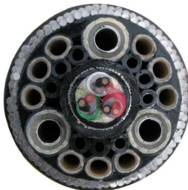
Рисунок 2.9 – Шлангокабели добывающей скважины (группа Prysmian, 2015)
