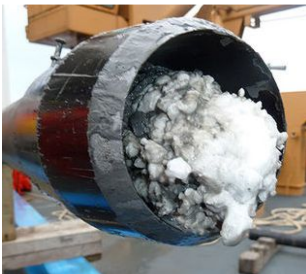
Рисунок 1.2 – Внешний вид гидратообразований в промышленном трубопроводе [2]
