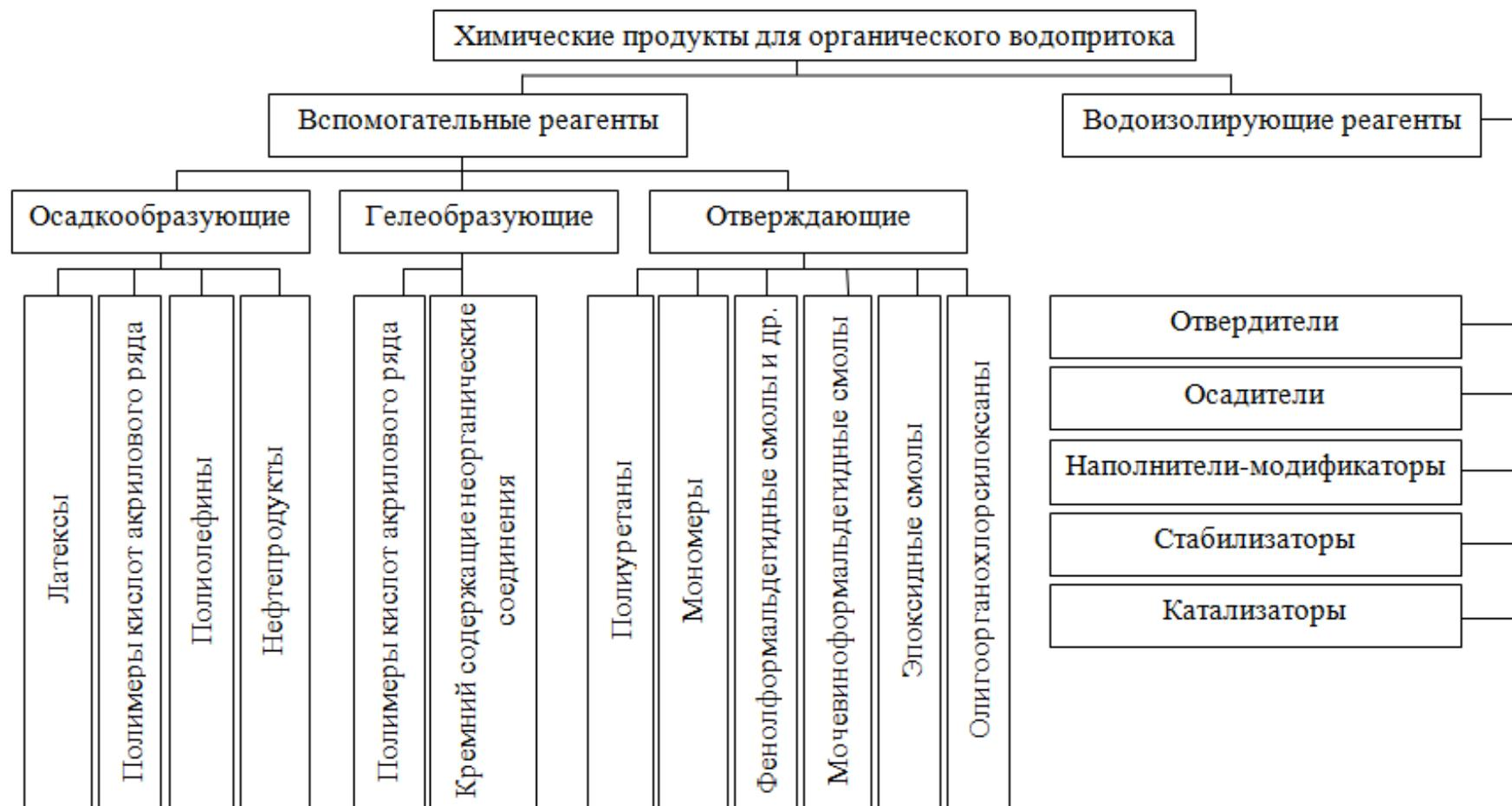
Рисунок 3 – Схема классификации химических реагентов для ограничения водопритока
