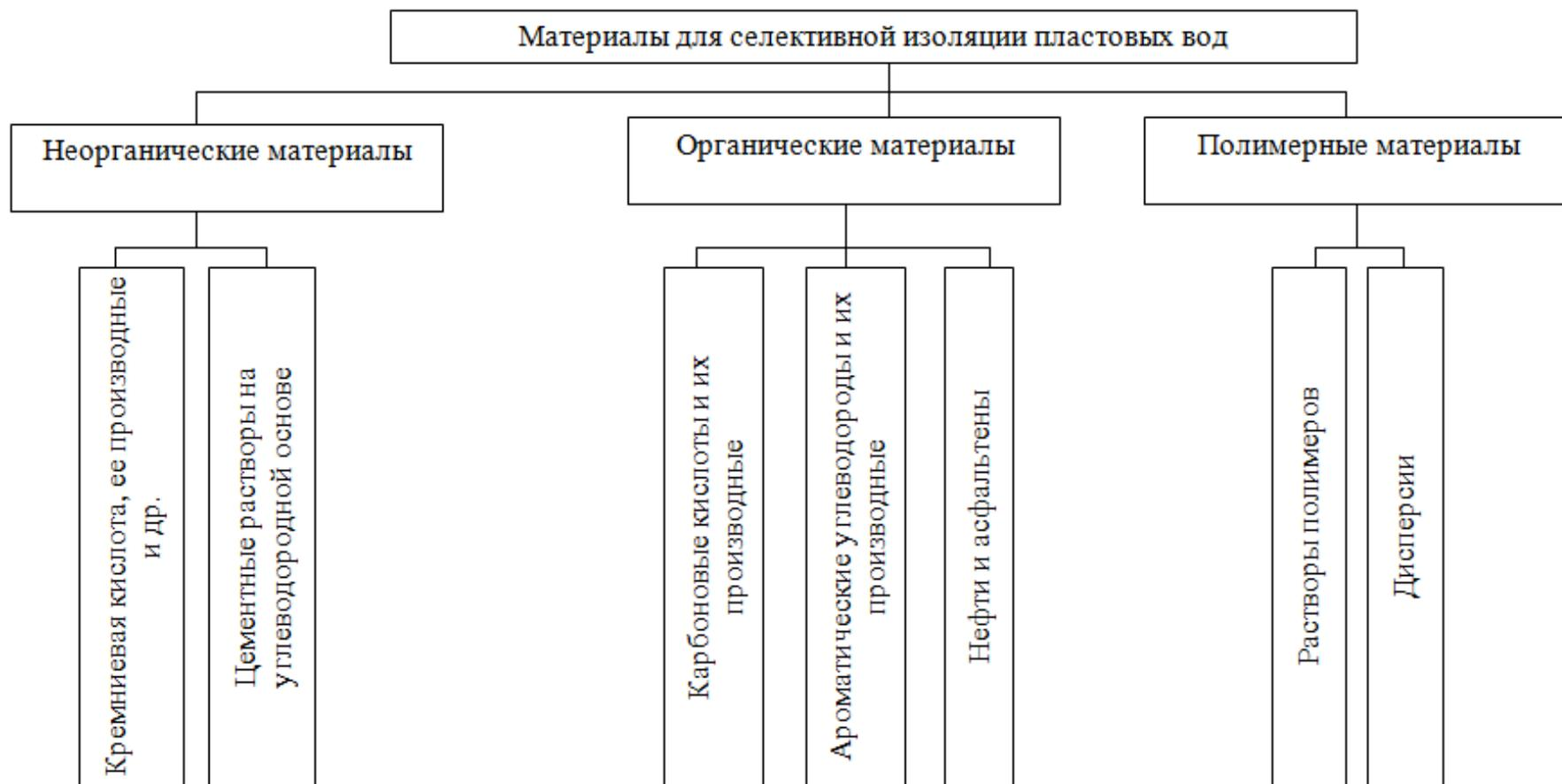
Рисунок 6 – Схема классификации материалов для селективной изоляции пластовых вод
