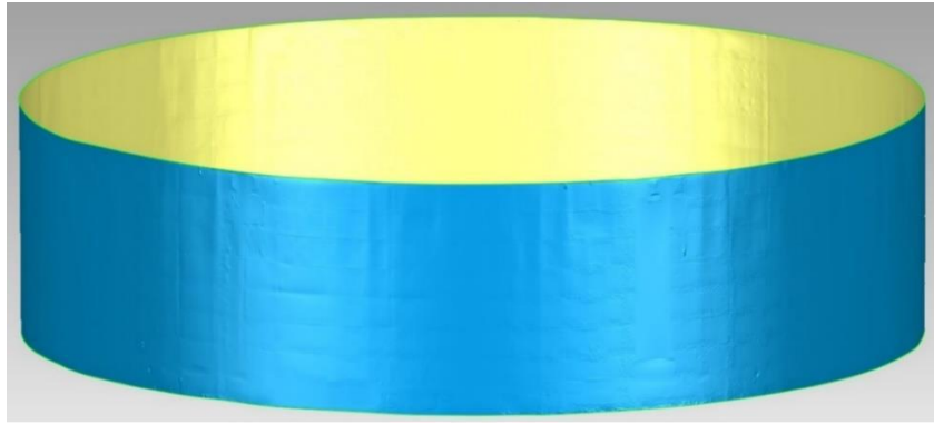
Рисунок 2.15 – Полигональная модель стенки резервуара РВСП-20000
