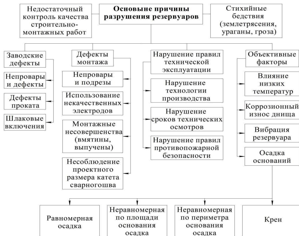
Рисунок 1.2 – Причины разрушения РВС по В.Б. Галееву
