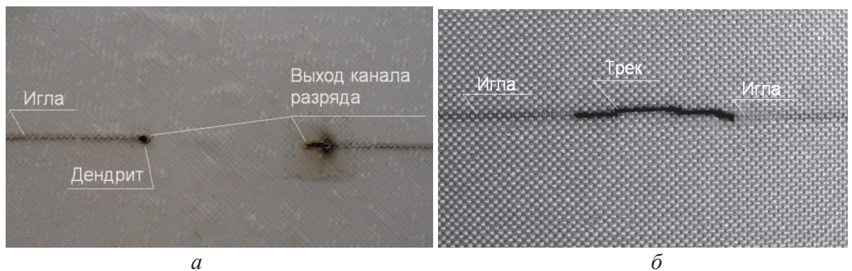
Рис. 4. Пробой исследуемого материала и выход канала разряда на его поверхность в композиции оргстекло–синтофлекс 616 (а) и развитие трекового канала на границе раздела слоев в композиции оргстекло–изофлекс (б)
