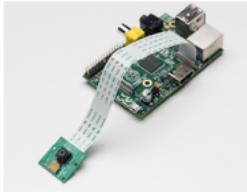
Рисунок 9 – Камера RPi, подключенная к Raspberri Pi
