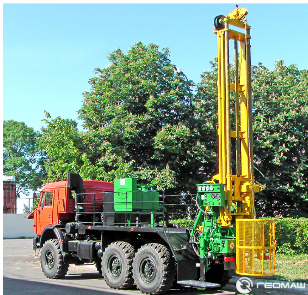
Рисунок 3.3.2 – Буровая установка ПБУ-2 на базе автомобиля КАМАЗ.
