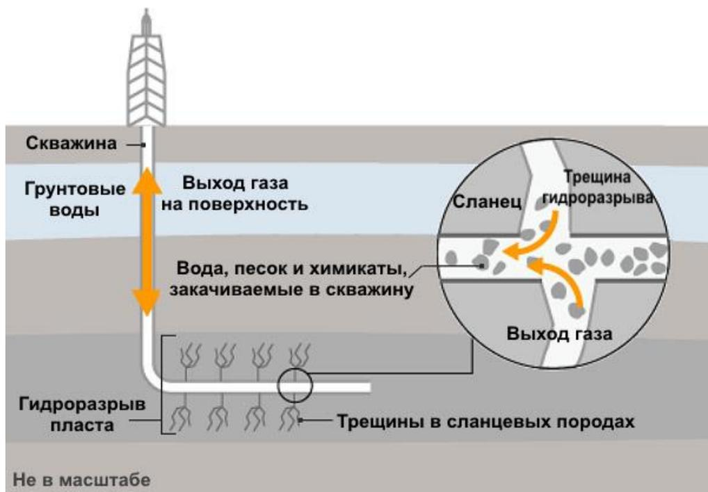
Рисунок 2.1. Общая схема гидроразрыва пласта.
