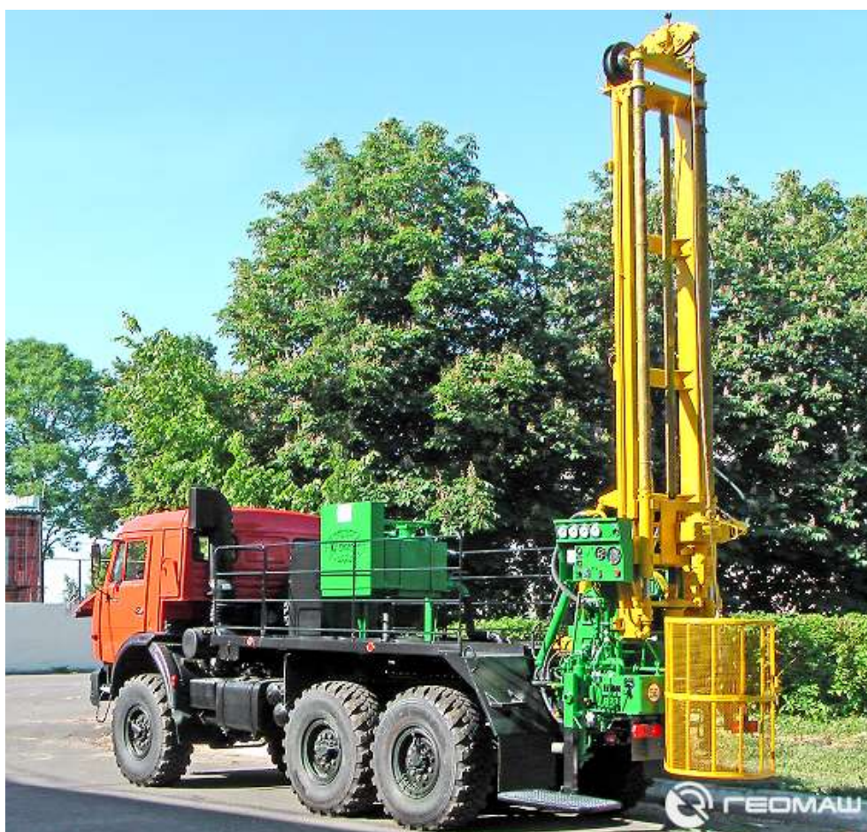
Рисунок 3.3.2 - Буровая установка ПБУ-2 на базе автомобиля КАМАЗ.
