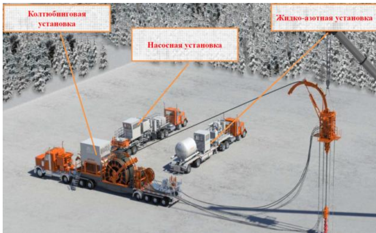
Рисунок 10 – Схема расстановки оборудования колтюбинговой установки
