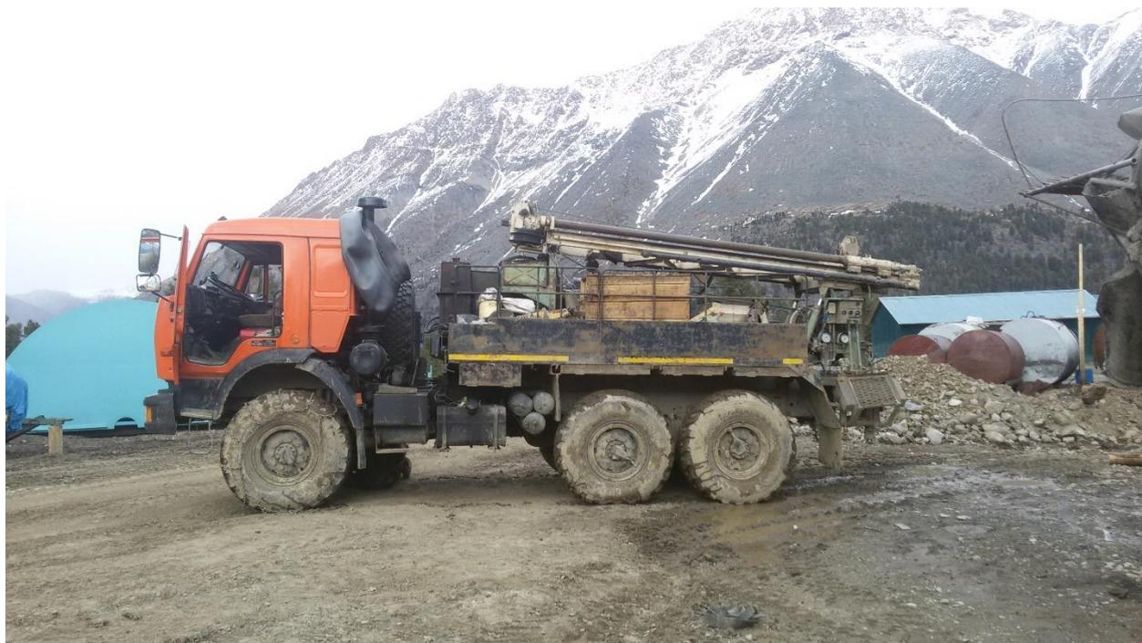
Рисунок 3.4 – Буровая установка ПБУ–2
