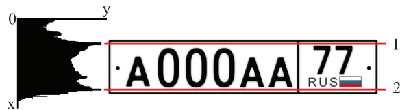
Рис. 2. Построение горизонтальных гистограмм. Линиям 1 и 2 соответствуют два наибольших максимума. x – номер строки изображения, y – средняя интенсивность строки изображения
